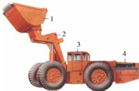
Рис. 5.14. Загальний вигляд вантажної машини для доставки ПД-8: 1 – вантажний орган; 2 – стріла; 3 – кабіна керування; 4 – силова установка
