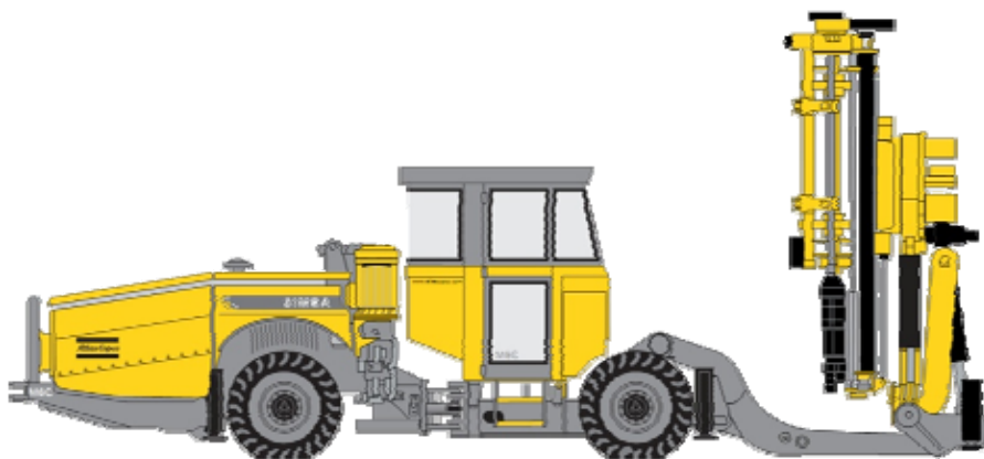
Рис. 3.19. Буровий верстат Simba M6C
