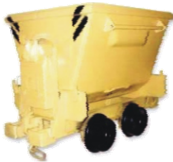
Рис. 10.12. Загальний вигляд вагонетки типу ВО-0,5 і ВО-0,8
