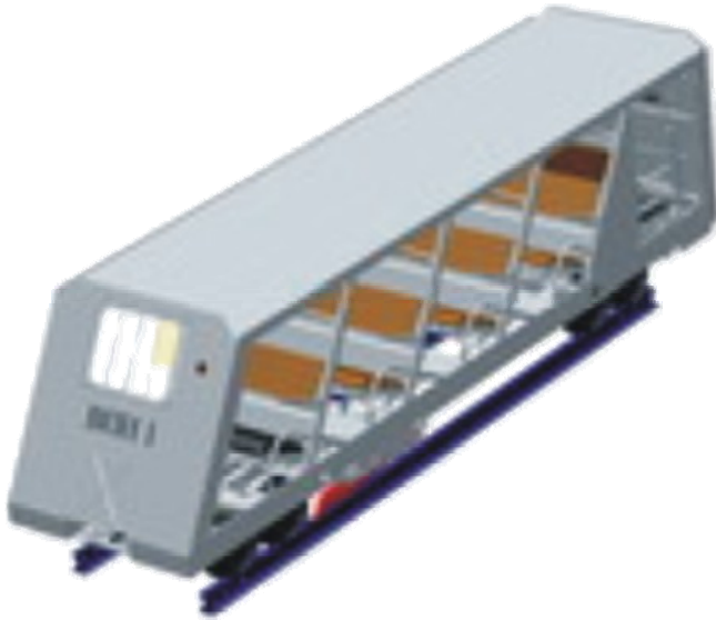
Рис. 10.15. Вагонетка пасажирська типу ВПН
