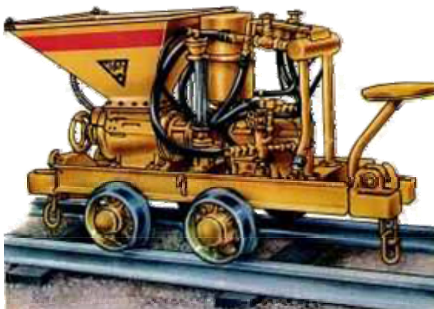
Рис. 7.16. Загальний вигляд зарядної машини ЗМБС-2
