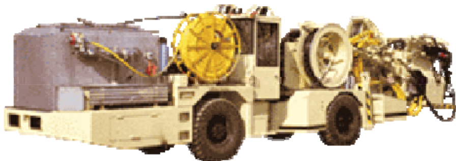
Рис. 7.20. Загальний вигляд зарядної машини Charmes 9825BE
