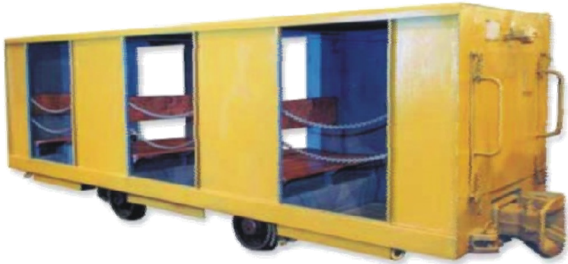
Рис. 10.14. Вагонетка пасажирська типу ВПГ
