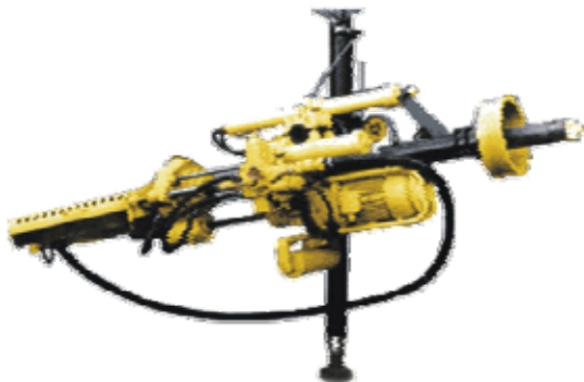
Рис. 3.3. Загальний вигляд бурового верстата типу НКР-100
