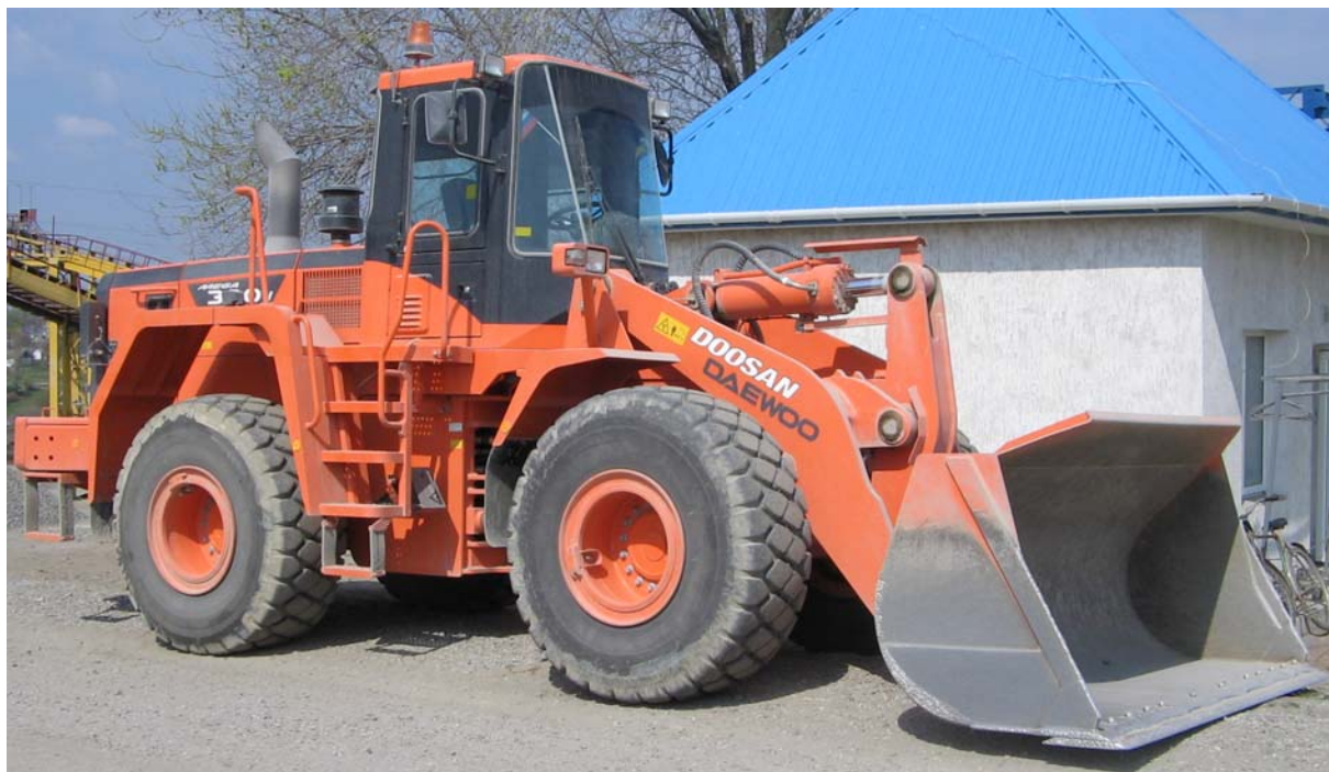
Рис. 4.8. Загальний вигляд одноківшевого фронтального пневмоколісного навантажувача для екскавації дрібно- та середньозернистих матеріалів
