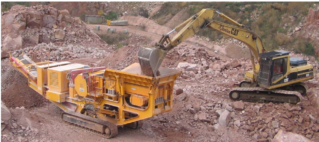
Рис. 5.2. Загальний вигляд СДА, виготовленого на базі щокowoї дробарки, у вибої гранітного кар’єру
