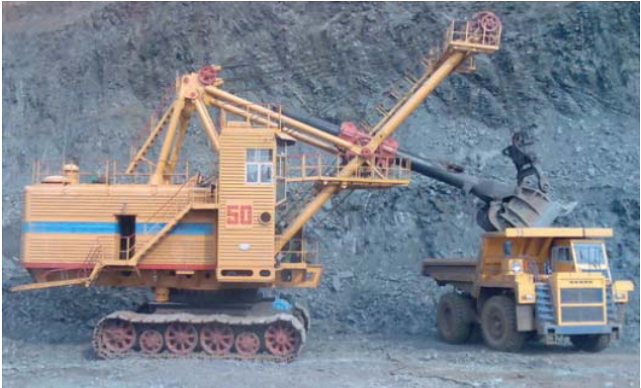
Рис. 3.9. Загальний вигляд одноківшового екскаватора з висувною рукояттю і канатним механізмом напорю
