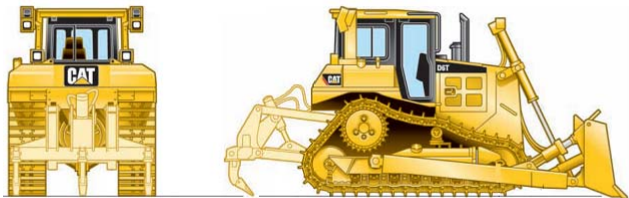
Рис. 4.3. Загальний вигляд бульдозера, обладнаного тристояковим розпушувачем
