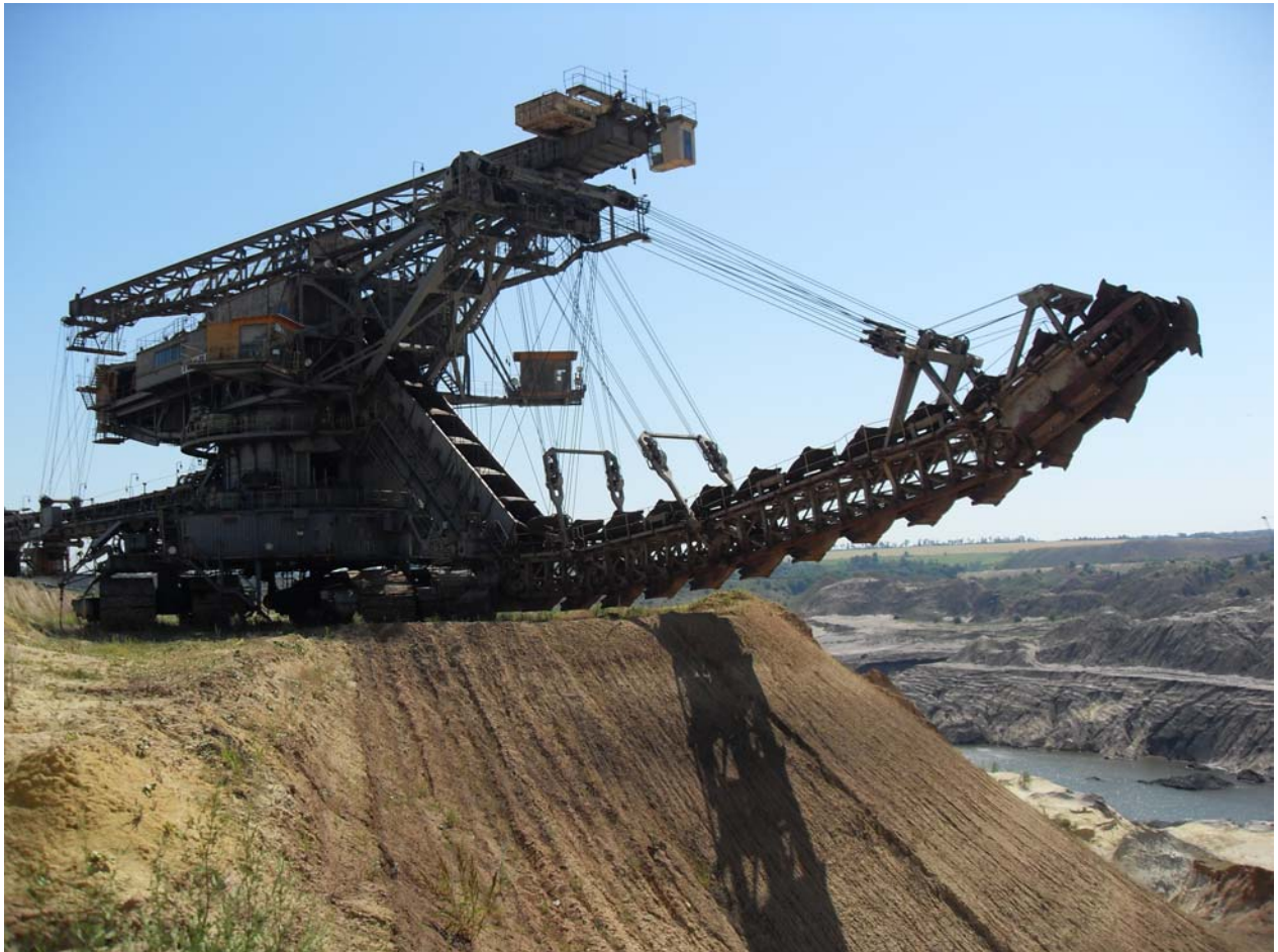
Рис. 3.24. Загальний вигляд ланцюгового екскаватора під час розкривних робіт на вугільному родовищі
