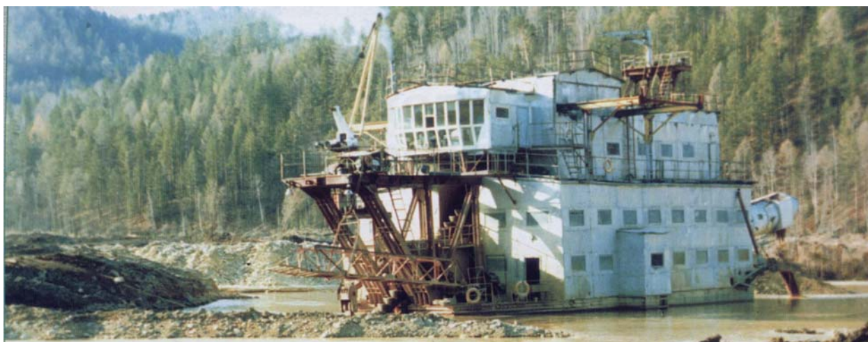
Рис. 6.10. Загальний вигляд драги 250ДМ для видобутку розсипного золота
