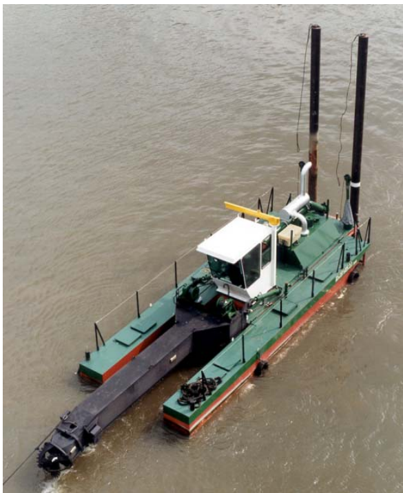
Рис. 6.9. Загальний вигляд землесосного снаряда виробництва ІНС Holland серії Beaver
