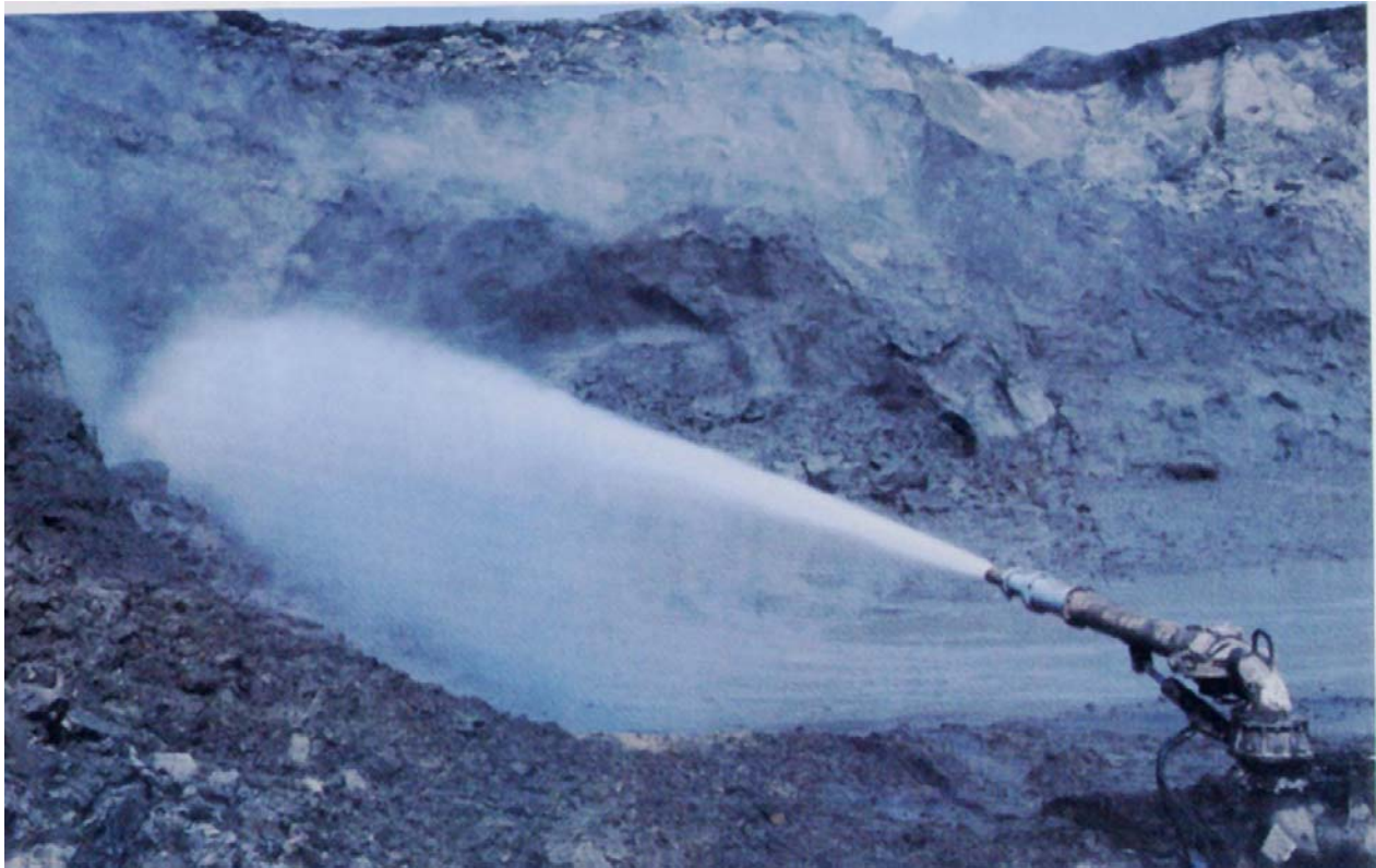
Рис. 6.1. Загальний вигляд гідромонітору у вибої
