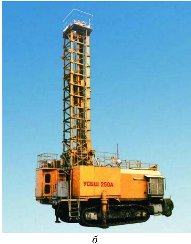
Рис. 2.3. Конструктивна схема (а) та загальний вигляд (б) верстата обертального буріння шарошковими долотами
