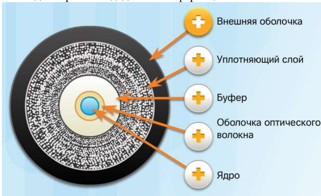
Рис. 1.1.38 Будова оптоволоконного кабелю
