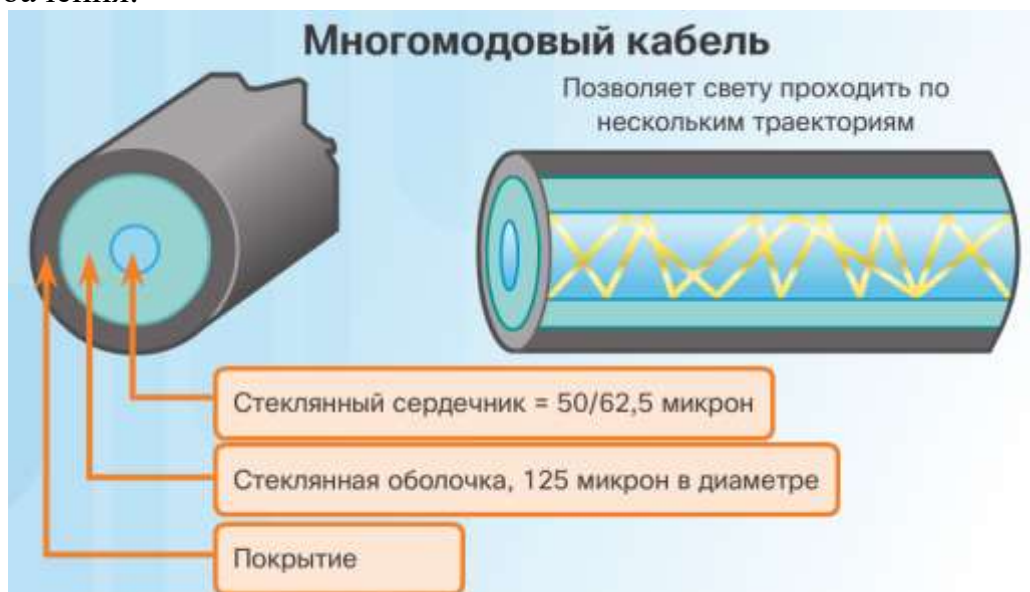
Рис. 1.1.40 Будова багатомодового оптоволоконного кабеля
