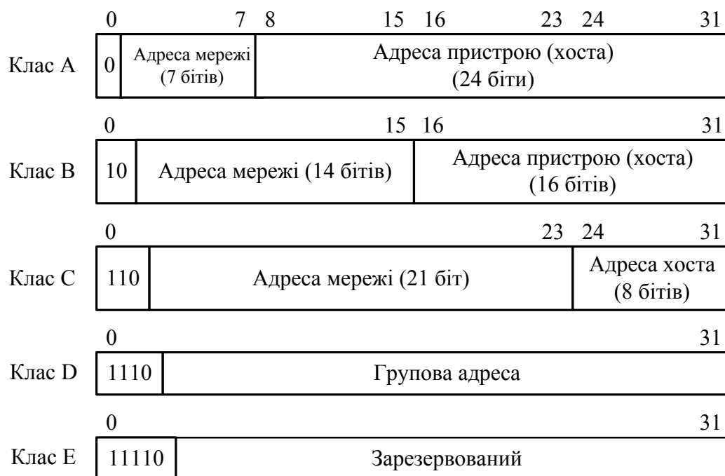
Рисунок 4.1 – Структури IP-адрес різних класів
