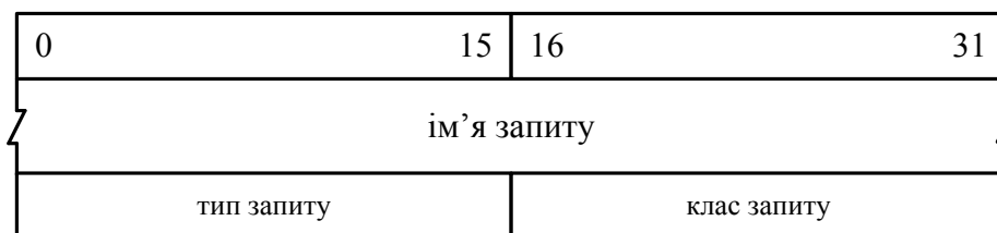
Рисунок 6.7 – Формат поля запитання DNS-повідомлення
