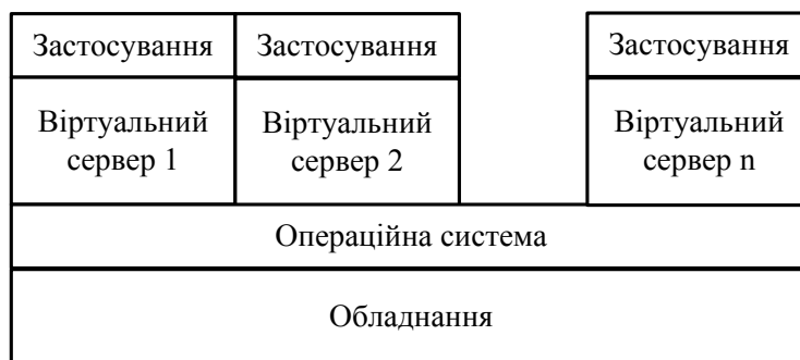
Рисунок 7.11 – Модель віртуалізації на рівні операційної системи
