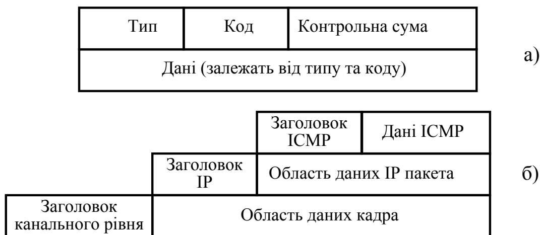
Рисунок 4.24 – Структура ICMP-повідомлення (а) та процедура його інкапсуляції в IP-пакет (б)
