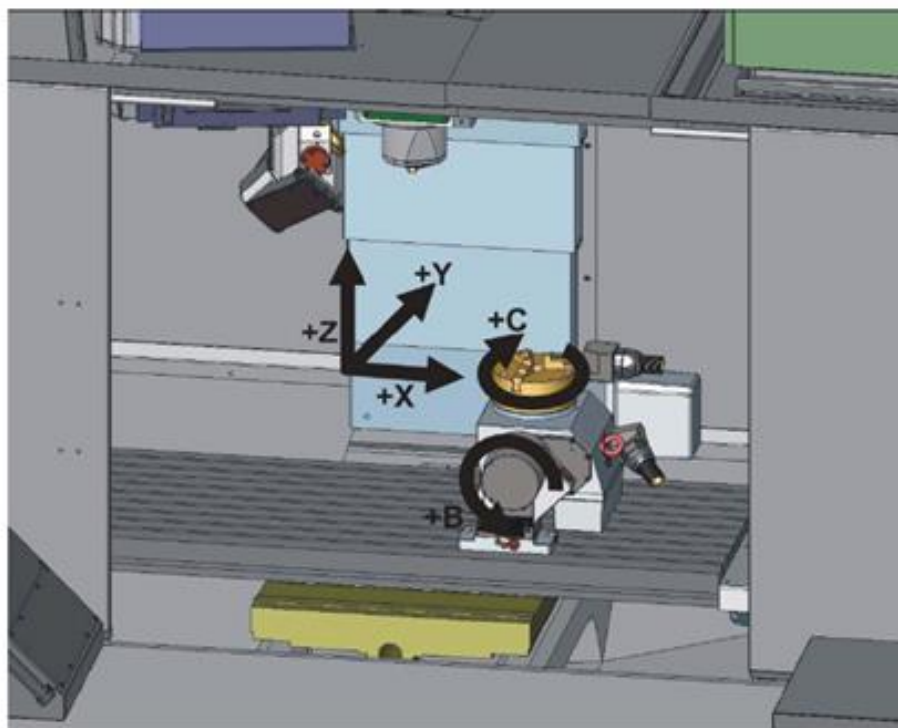
Рис.5.7. Робоча зона та системи координат фрезерно-свердильного верстата
