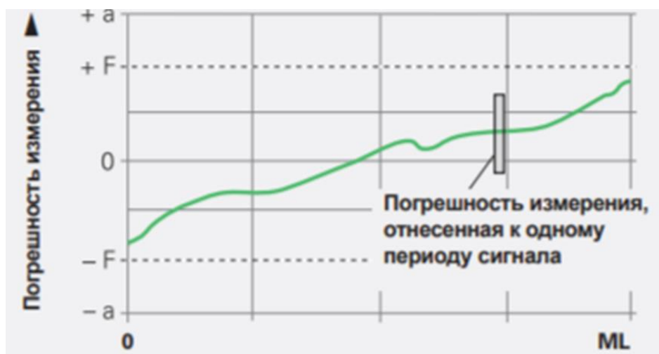
Рис. 4.11. Похибка вимірювання a , що віднесена до всієї довжини шкали
