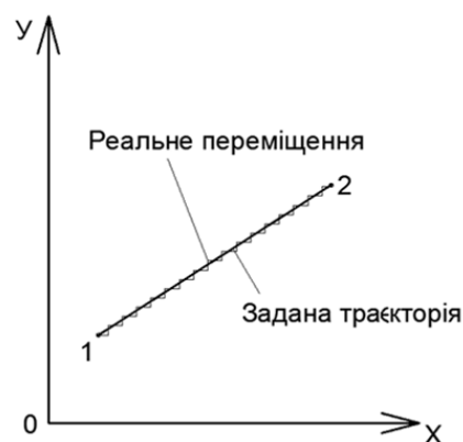
Рис.5.1. Переміщення робочого столу під кутом до осі
