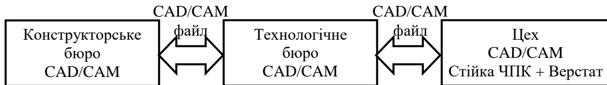
Рисунок 2.2 – Економічна схема програмування верстата з ЧПК
