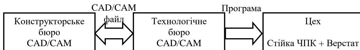
Рисунок 2.1 – Традиційна схема програмування верстата з ЧПК
