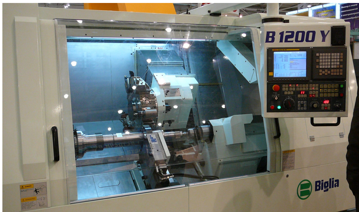
Рисунок 1.6 — Робоча зона багатоцільового токарного верстата з ЧПК моделі B1200Y
