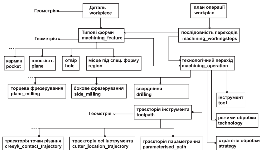
Рис. 2.44. Керуюча інформація (компоненти функціональності) відповідно до стандарту ISO 14649
