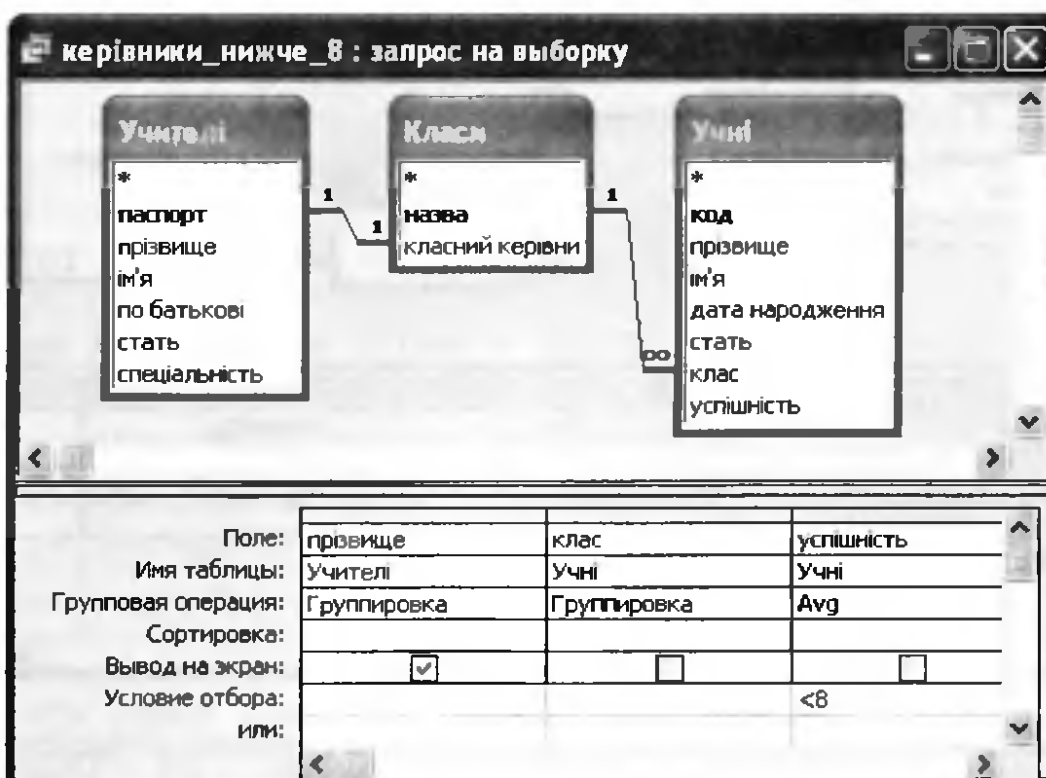
Рис. 10.4. Вікно конструктора запиту «Визначити прізвища класних керівників тих класів, середня успішність у яких нижча за 8 балів»
