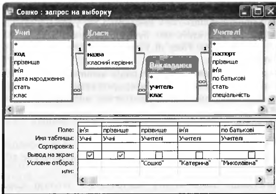
Рис. 8.10. Вікно конструктора запиту «визначити імена та прізвища учнів, у яких викладає Сошко Катерина Миколаївна»
