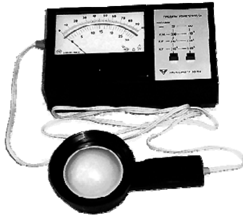
Рис. 3.1 Прибор для вимірювання освітленості – люксометр Ю-116
