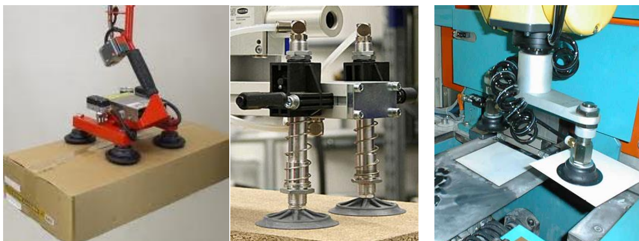
Рис.8.77. Приклади вакуумних ЗП для різних об'єктів виробництва: а – ЗП для затиску картонних виробів; б – ЗП для затиску деревинних виробів; в – ЗП для затиску керамічних виробів
