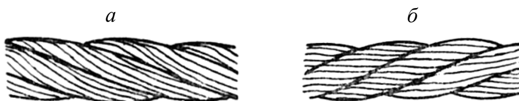
Рис. 3.4. Канати з односторонньою (а) і з хрестовою завивкою (б)
