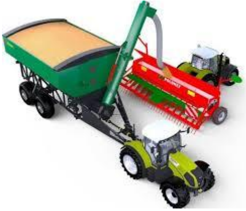
а) Універсальний агрегат при завантаженні сівалки
