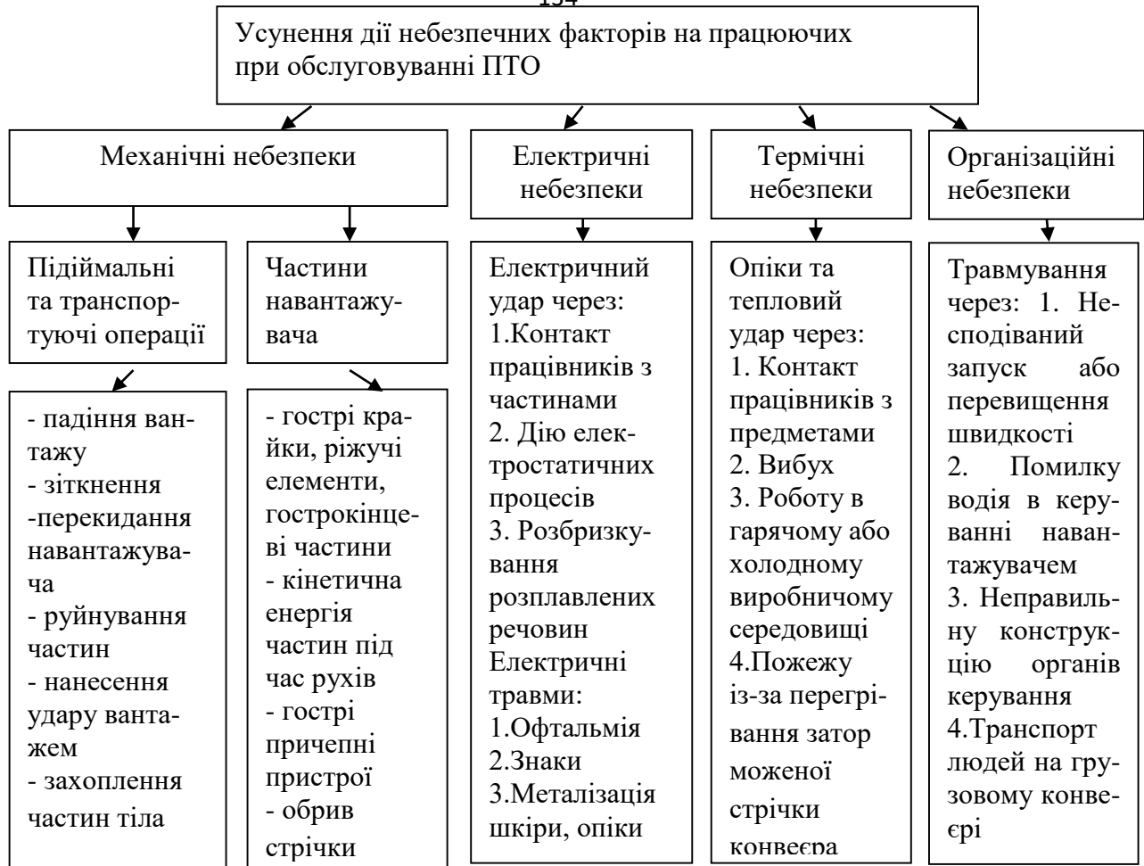
Рис. 5.2. Усунення дії небезпечних факторів на працюючих при обслуговуванні підйомно-транспортного обладнання
