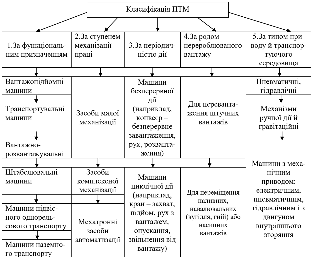
Рис. 1.3. Класифікація підйомно-транспортних машин
