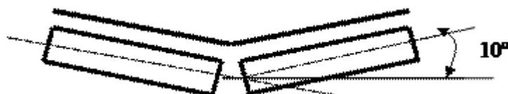
Рис. 4.8. Розташування роликів і стрічки
