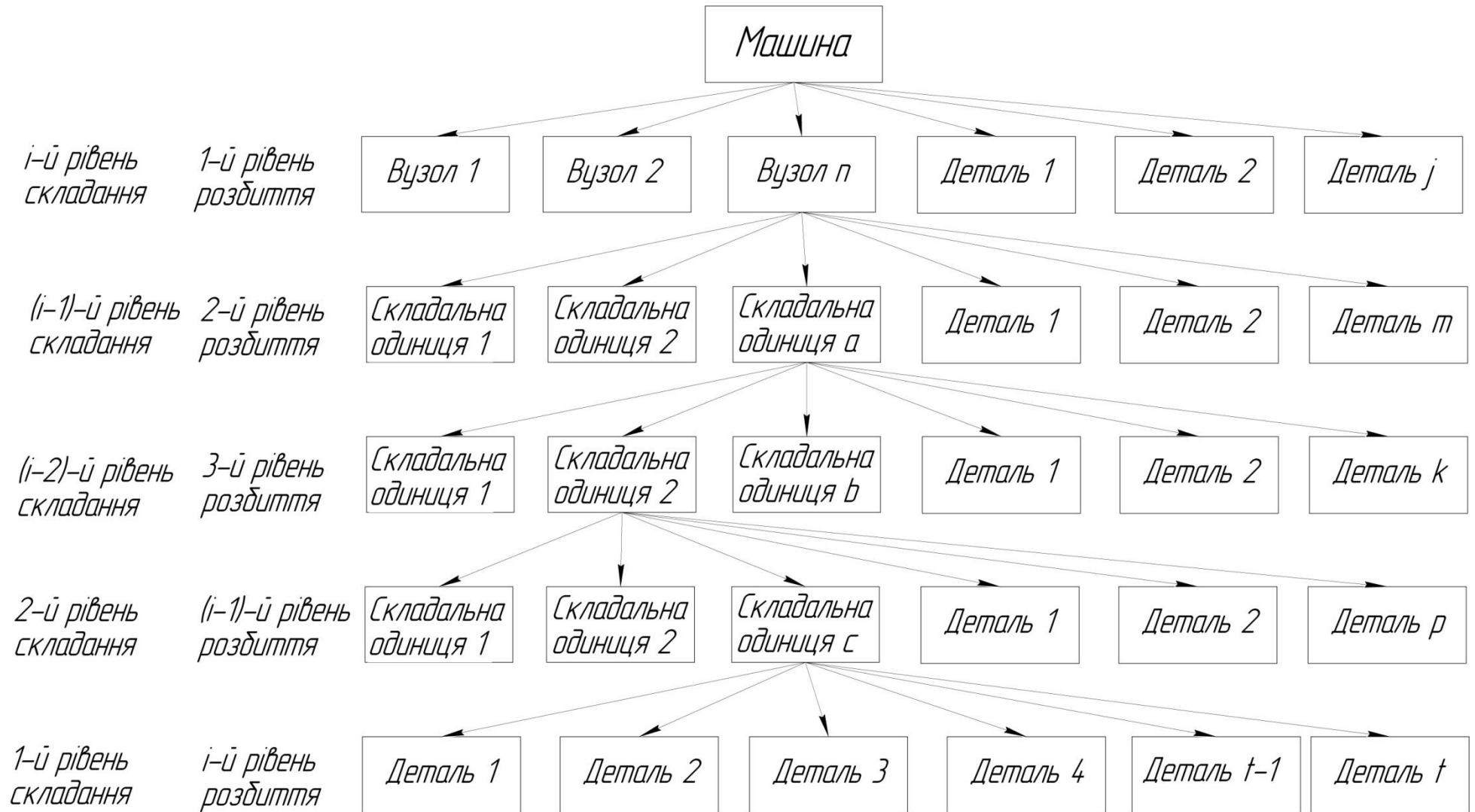
Рисунок 1.1 - Схема розбиття (розбирання) і складання машини
