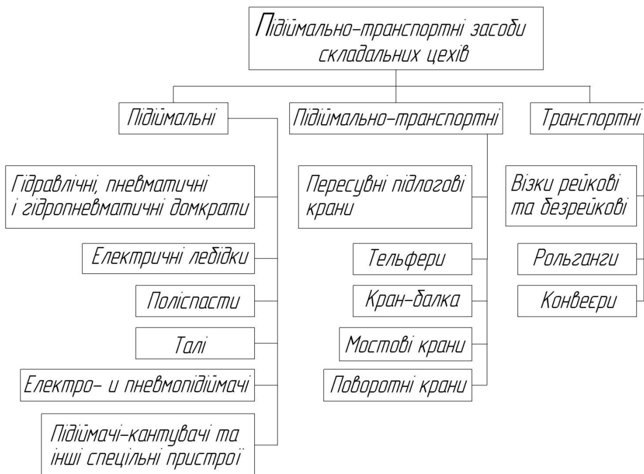
Рисунок 6.1 - Підіймально-транспортне обладнання складальних цехів
