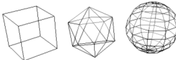
Рис. 1.7. Каркасні тривимірні моделі
