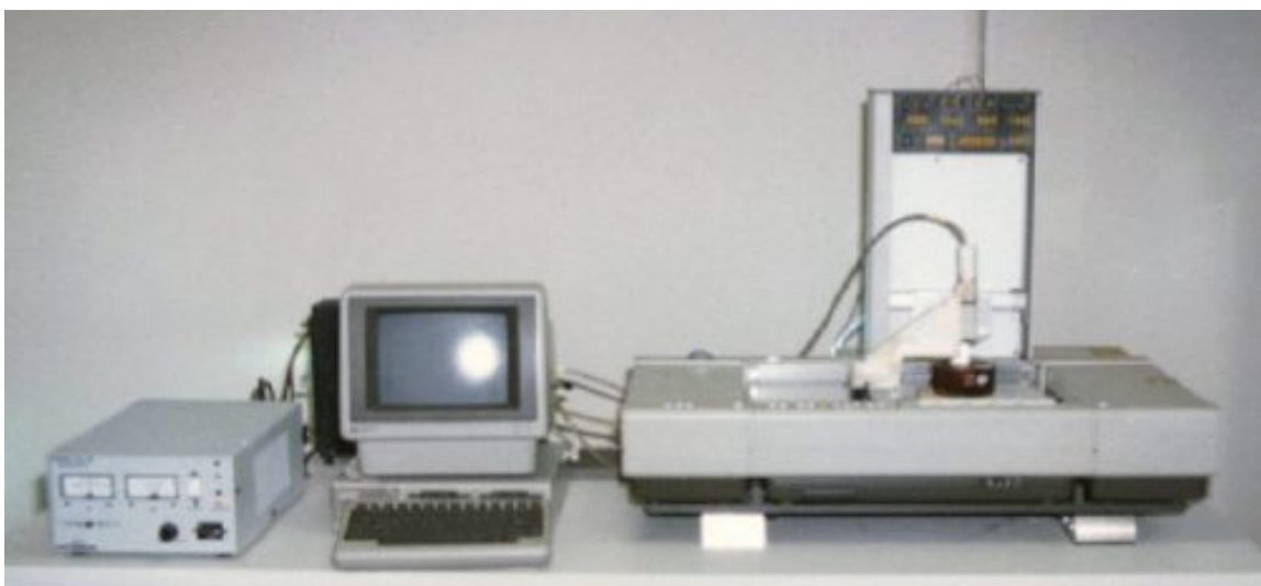
Рисунок 1.1 – Загальний вигляд першого 3D принтера, розробленого Чаком Халлом
