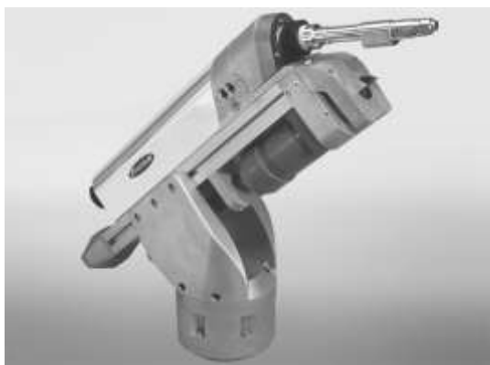
Рис. 11.23. Спеціалізована зварювальна головка для гібридного лазерно-дугового зварювання
