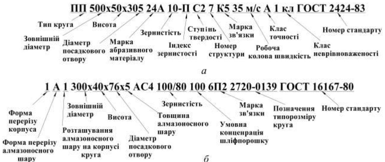
Рис. 29.2. Приклади маркування абразивного (а) і алмазного (б) шліфувальних кругів
