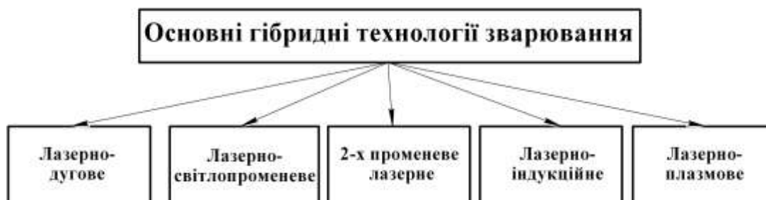
Рис. 11. 21. Основні гібридні способи зварювання
