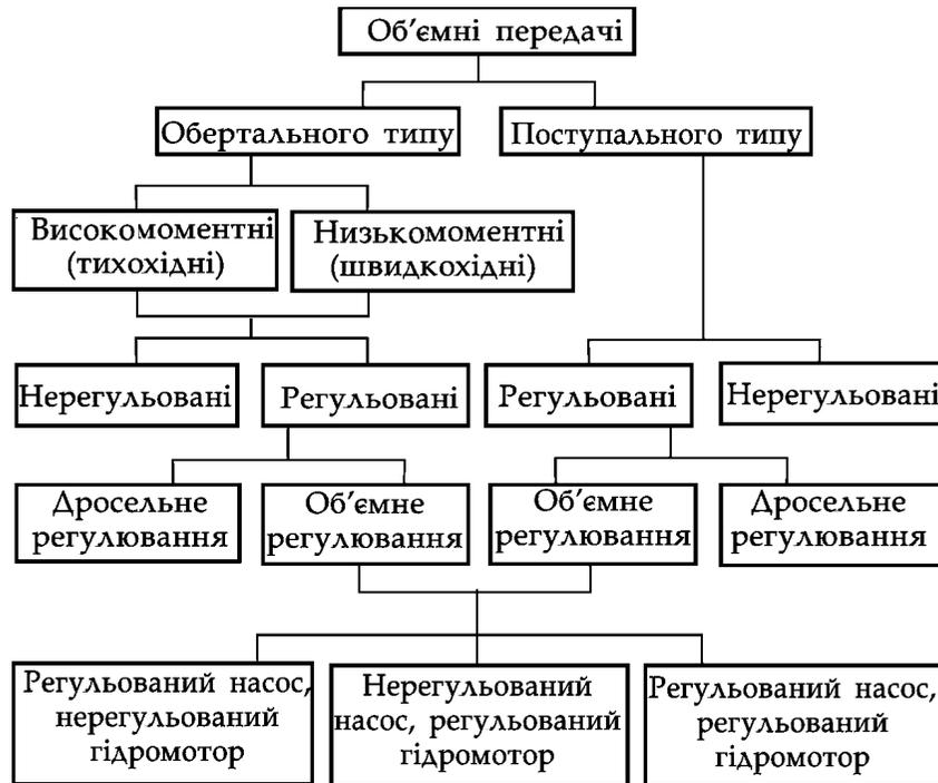
Рис. 14.11. Класифікація об'ємних гідропередач гідростатичного приводу
