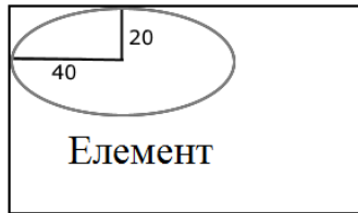
Рис. 3.25. Заокруглення кутів елемента еліптичною дугою
