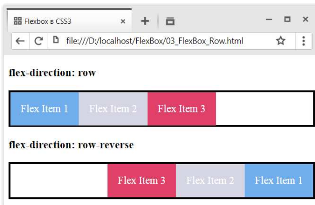
Рис. 3.52. Розташування флекс-елементів у вигляді рядка
