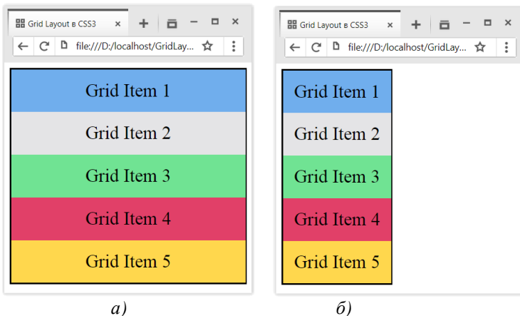
а) б) Рис. 3.71. Властивість display: а – значення grid ; б – значення inline-grid .
