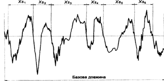
Рис. 4.10. Ширина елементів профілю [ДСТУ ISO 4287 рис.10, с.3]
