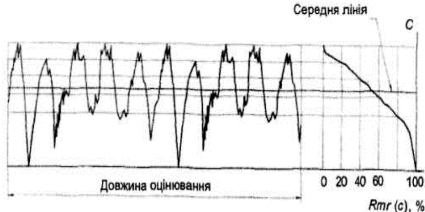
Рис. 4.11. Відносна опорна крива [ДСТУ ISO 4287 рис.11, с.3]
