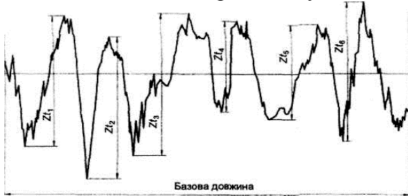
Рис. 4.9. Висота елементів профілю (приклад шорсткості профілю) [ДСТУ ISO 4287 рис. 9, с.3]
