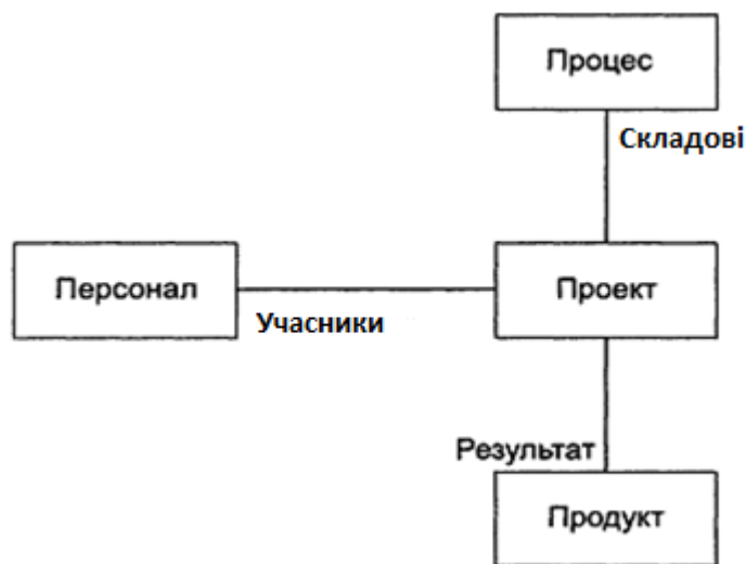
Рис.1.6. Зв'язок елементів еталонної моделі інженерії ПЗ.
