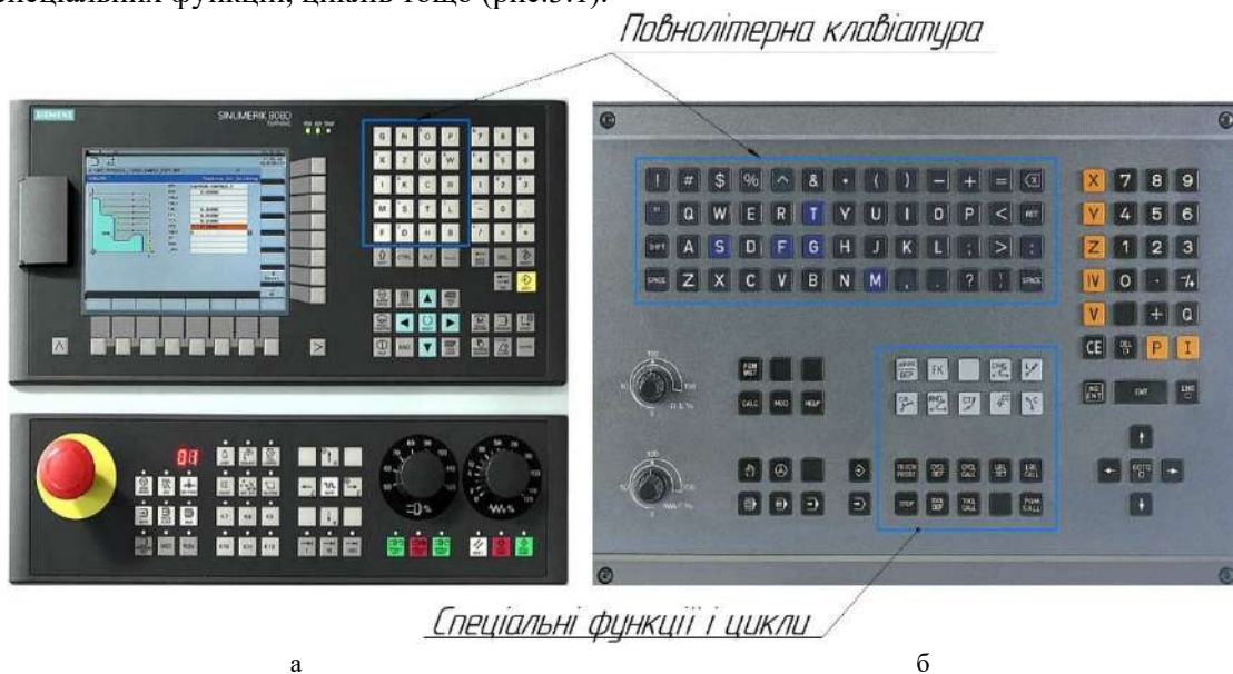
Рисунок 3.1 – Приклади пультів керування систем ЧПК з можливостями ручного вводу керуючих програм (HNC). а – пульт керування верстата з ЧПК системи Sinumerik 808D; б – пульт керування верстата з ЧПК системи iTNC-530
