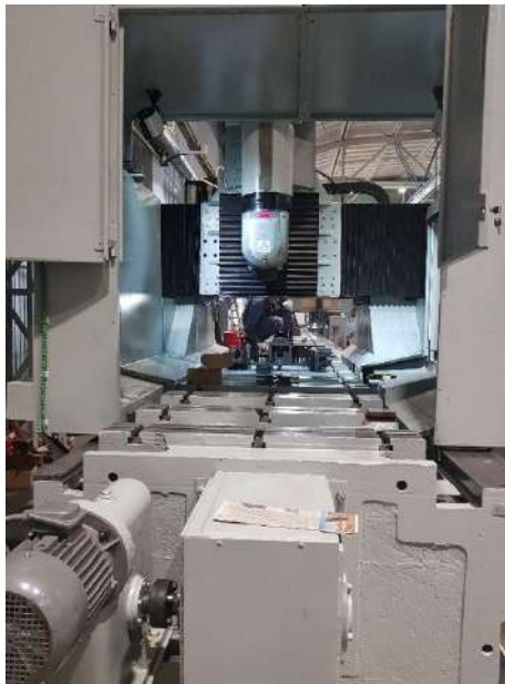
Рисунок 4.5 – Перетворення двоportalного верстата ПФП-5 в обробний центр
