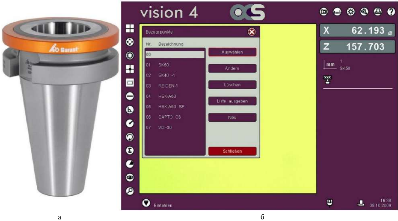
Рисунок 3.15 – Перехідна втулка GARANT SK-50 на HSK-63 (а) і перелік налаштувань нульових точок для різних типів хвостовиків на приладі для налаштування різального інструменту Alfa-set 23 (б)
