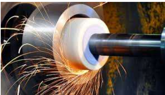
Рис. 10.50. Процес шліфування внутрішніх циліндричних поверхонь та види шліфувальних кіл.
