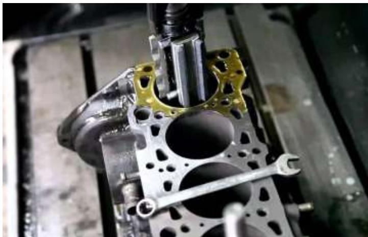
Рис. 10.56. Процес хонінгування блоку циліндра (а) та приклад хона (б).
