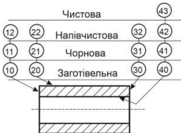
Рис. 9.5. Схема етапів обробки порожнистого валу.
