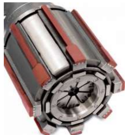
Рис. 10.56. Процес хонінгування блоку циліндра (а) та приклад хона (б).
