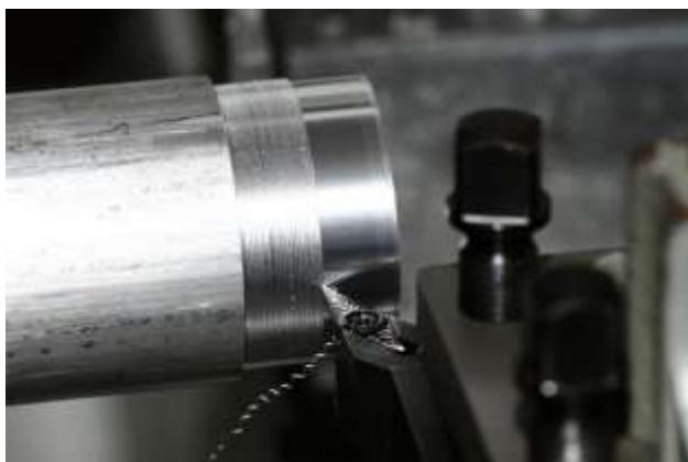
Рис. 10.2. Процес точіння та конструкції різців зі знімними пластинами.
