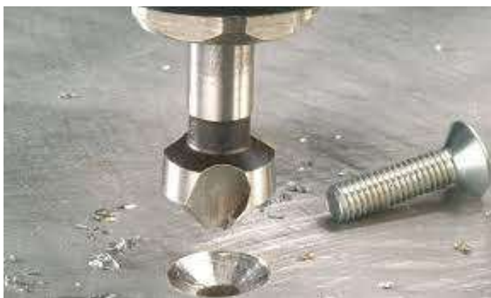
Рис. 10.41. Операція зенкування посадкової поверхні під головку гвинта.
