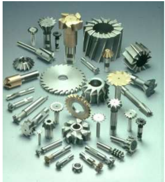
Рис. 10.62. Процес фрезерування та різні типи фрез.
