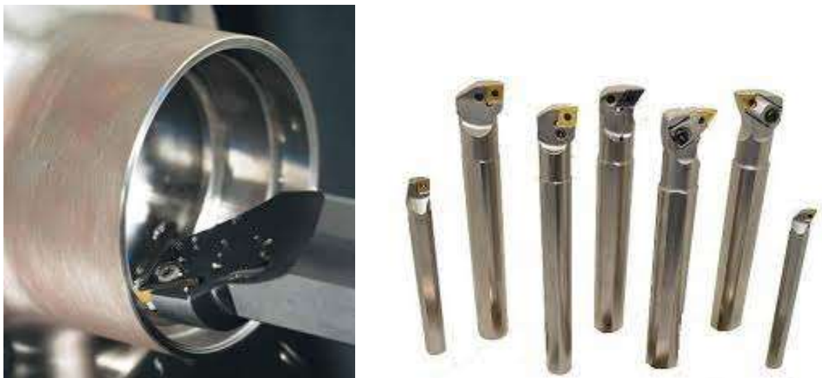
Рис. 10.46. Процес розточування та ріжучий інструмент.
