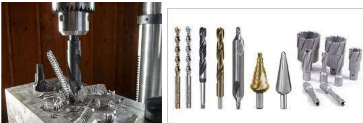
Рис.10.23. Процес свердління та ріжучий інструмент.
