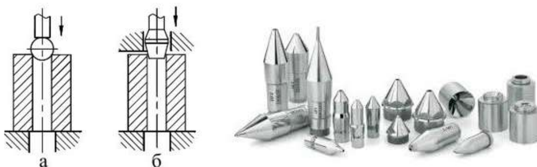
Рис. 10.59. Конструкції дорнів: а – кульова; б - однозуба зустрічних конусів; в – елементи конструкції дорнів .
