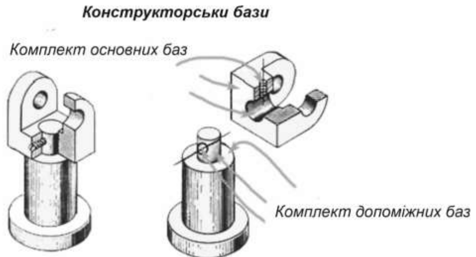
Рис. 4.3. Приклад розташування конструкторських баз.
