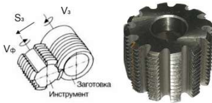
Рис. 10.100. Схема нарізування різьблення гребінчастою фрезою та загальний вигляд фрези.
