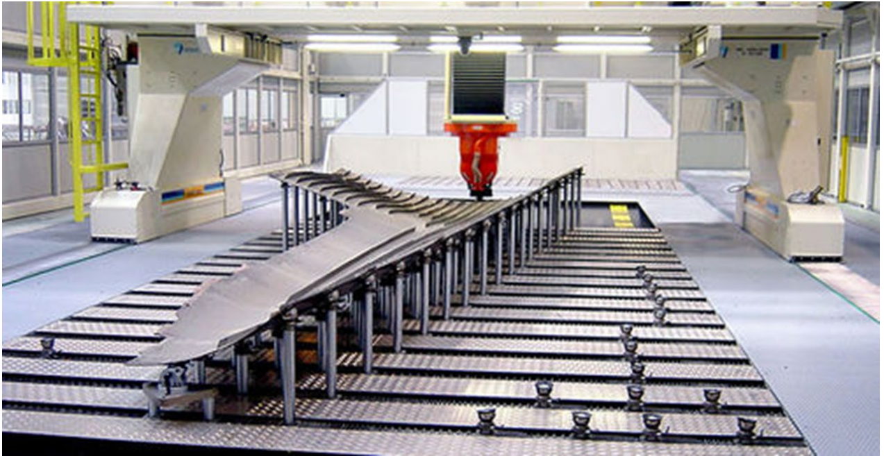
Рис. 35. Вертикальний фрезерний верстат з ЧПУ для авіації / 5 і більше осей. TORRESMILL®M.TORRES DISEÑOS INDUSTRIALES S.A.U.
