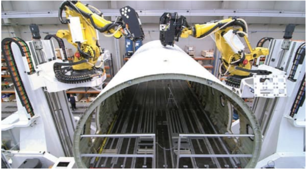
Рис. 48. Роботизований комплекс свердління-зенкування та клепки фюзеляжів літаків (Фото igus)
