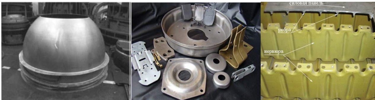
Рис. 22. Штамповка оболонки побутового відсіку з сплаву АД1, : \varnothing – 2500 мм; h – 1500 мм; товщина – 2...3 мм (а); деталі, отримані листовим штампуванням (б); штамповані з листа нервюри (в).
