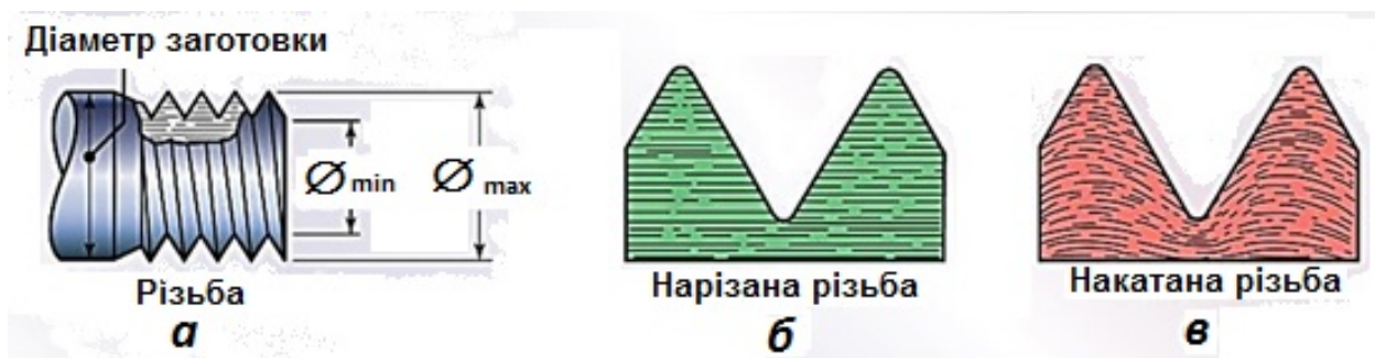
Рис. 32. (а) Особливості нарізаної або накатаної різьби. Мікроструктура в (б) нарізаних і (в) накатаних різьбах. На відміну від механічної обробки, яка прорізає зерна металу, накатка різьби надає підвищену міцність через холодну деформацію і сприятливу волокнисту структуру, яку утворюють зерна в результаті пластичної течії.
