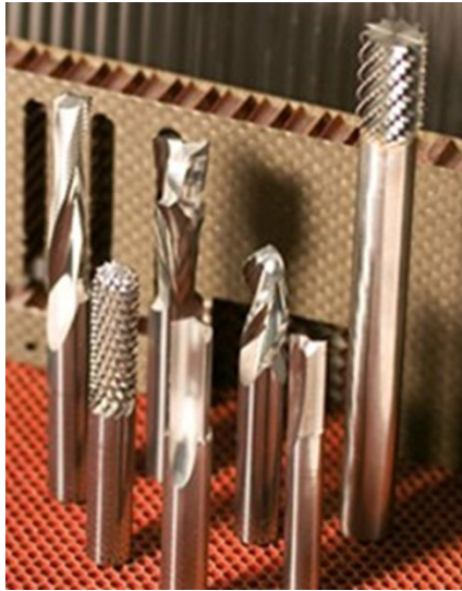
Рис. 92. Приклади інструменту для механічної обробки
