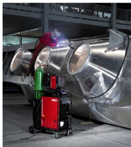
Рис. 56. Аргоно-дугове зварювання алюмінію в захисних газах (MIG/TIG). MIG - дугове зварювання плавким електродом у захисному інертному газі TIG - дугове зварювання неплавким (вольфрамовим) електродом у захисному інертному газі
