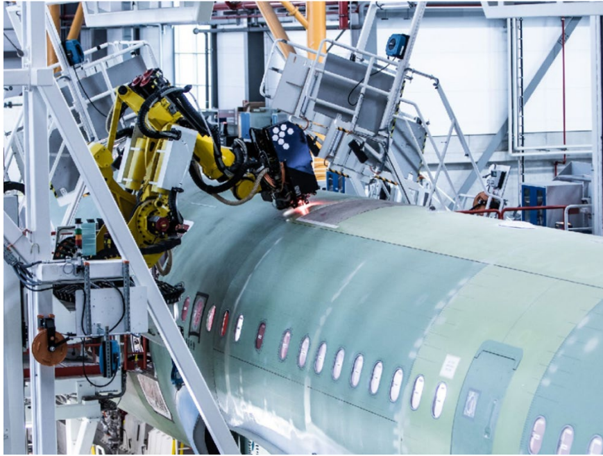
Рис. 59. Лазерне зварювання при складанні літака А318 корпорацією Airbus дозволило зменшити вагу і прискорити його виробництво. На нижніх панелях фюзеляжу А320 застосоване лазерне зварювання стрингерів та обшивки, що суттєво зменшило кількість кріплення.
