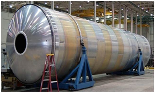
Перша ступінь Falcon 9, виготовлена з сплаву 2198 із застосуванням ЗТП (зварювання тертям з перемішуванням)
