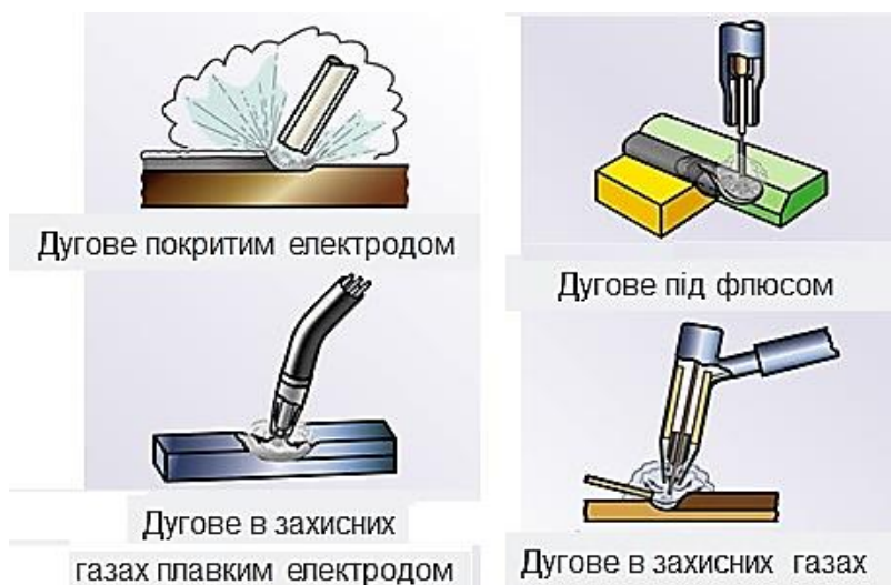
Рис.54. Деякі термічні способи зварювання
