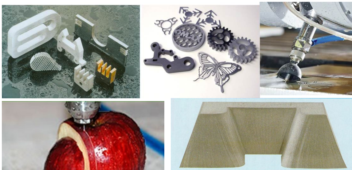
Рис. 72. Приклади деталей, отриманих гідроабразивним різанням (а,б,д), кутова головка (в) - система з додатковими координатами для вирізання 3-вимірних деталей, нарізання продуктів харчування (г).
