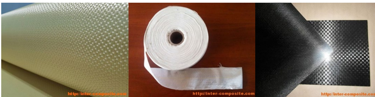
Рис. 82. Приклади препрегів: кевлар, стрічка зі скловолокна, карбонова пластина
