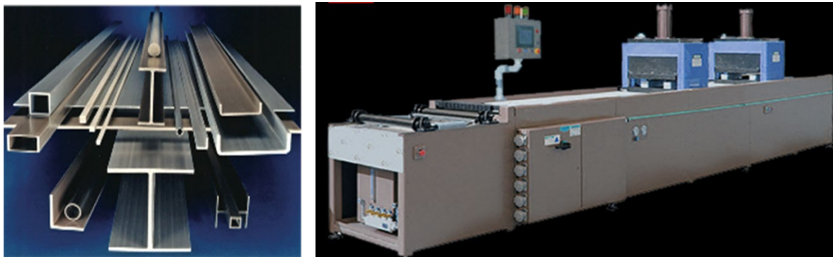
Рис. 88. а) Приклади деталей, отриманих пултрузією, (б) Пултрузійна машина.
