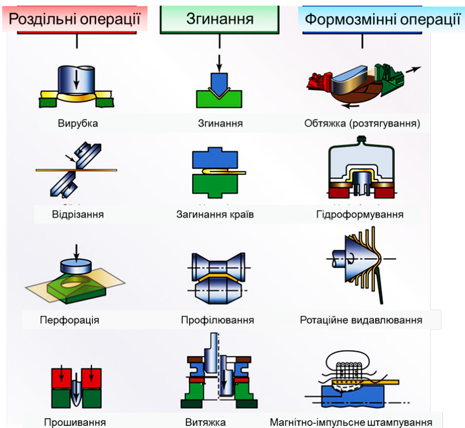
Рис. 14. Операції листового штампування
