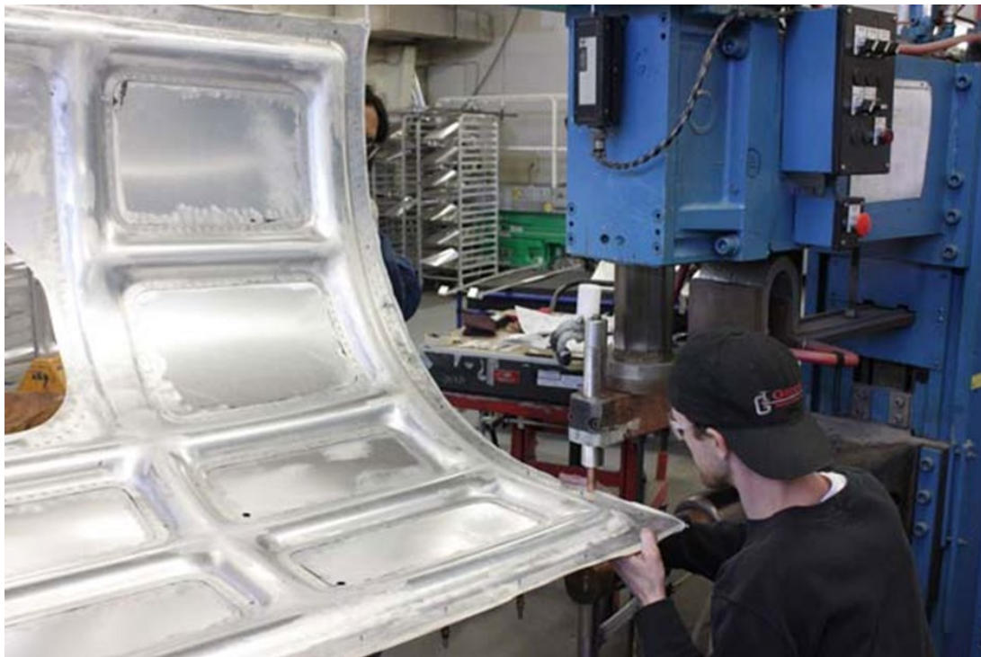
Рис. 60. Зварювання елементів панелі способом електричного контактного точкового зварювання (в Lynn Welding)
