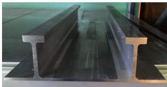
Рис. 61. Варіанти виготовлення панелей: клепана, зварена лазерним променем, зварена методом зварювання тертям з перемішуванням.
