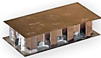
Рис. 58. Приклади застосування зварювання (також, паяння) у виробництві стільникових панелей та турбінних лопаток
