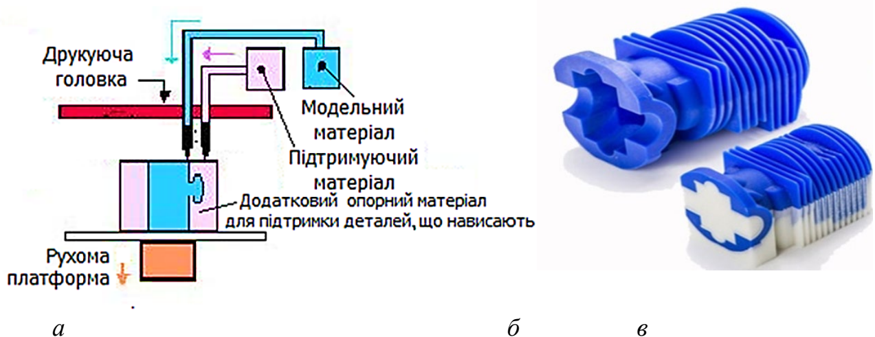
Рис. 6. Схема технології 3D-друку воском ( a ), готова воскова модель ( б ), надрукована модель з опорним матеріалом, який треба змити ( в )
