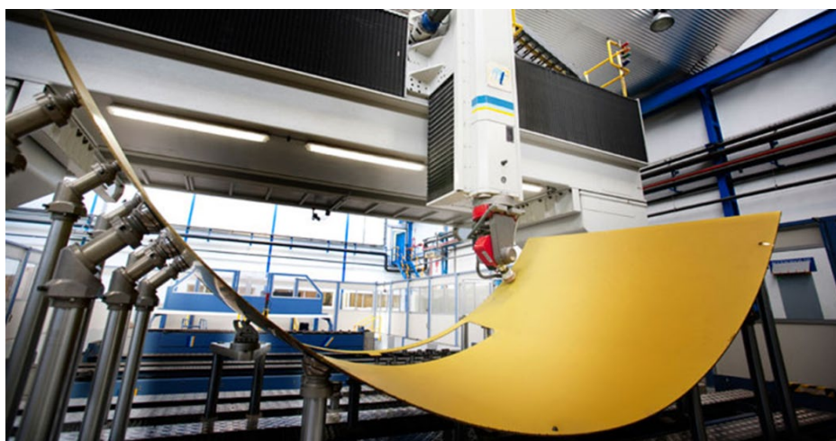
Рис. 70. 5-осьовий порталний високошвидкісний лазерний верстат DNC-CNC TORRESLASER® спеціально розроблений для високошвидкісного лазерного розкрою панелей літаків
